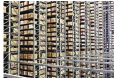
Die zwei Hochregallager, jeweils 100 Meter lang und 80 Meter breit, bilden das Herzstück des Logistikzentrums. Ein wahrhaft beeindruckendes Bild: In 30 Meter hohen Stahlgerüsten sind 1,2 Millionen Kartons gestapelt. Reihte man sie aneinander, ergäbe es eine 600 Kilometer lange Strecke. Trotz Reih' und Glied, die Lagerhaltung ist „chaotisch“: Camcorder liegen neben Blusen, Uhren neben Tischdecken.
